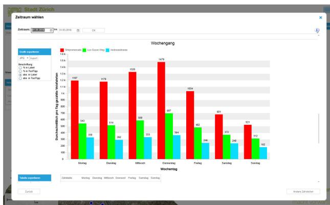
Abb. 4: Eine Stärke neuer Erhebungsmethoden ist die schnelle Datenverfügbarkeit und die Vollständigkeit der erhobenen Daten. Die Stadt Zürich hat eine Internetapplikation zur Analyse und Visualisierung der Velozählungen aus den automatischen Dauerzählstellen etabliert. Bild: Stadt Zürich, Tiefbauamt
