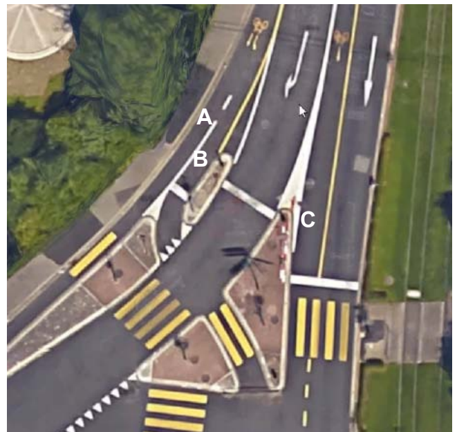
Abb. 3: Kreuzung in Basel mit Velofurt (A), indirektem Linksabbieger (B, für unsichere Velofahrer) und direkter Verbindung für geübte Velofahrer (C) (Foto: Google)
