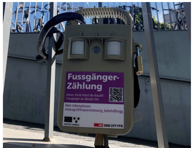
Abb. 4: Wärmebildkamera zur Kalibrierung der Bluetooth-/WiFi-Daten, Testerhebung am Bahnhof Brugg
