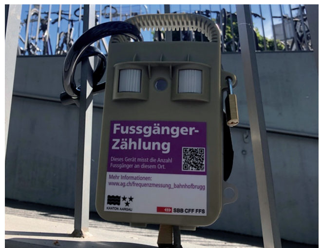
III. 4 : Caméra thermique pour le calibrage des données Bluetooth/WiFi, relevé pilote à la gare de Brugg
