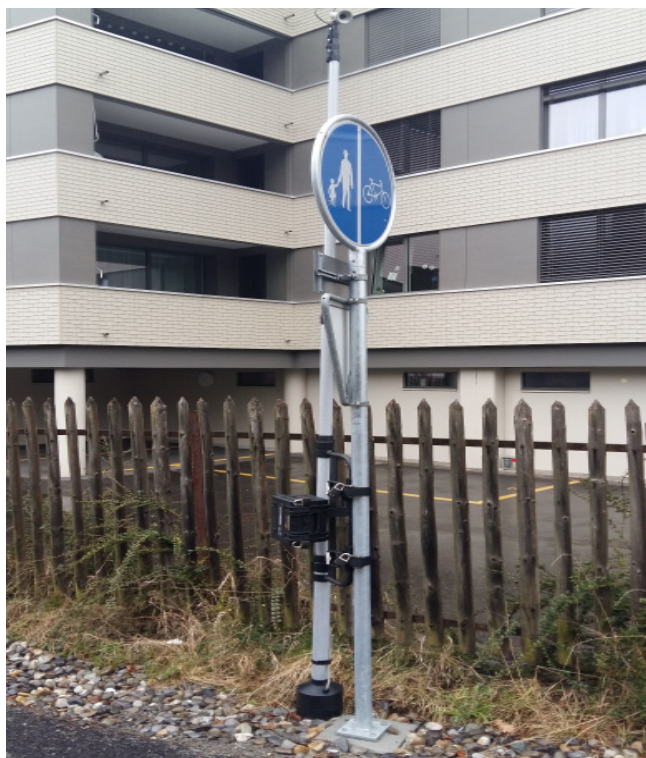
Fig. 5 : Comptage à l'aide d'une caméra à Lucerne. La force des méthodes basées sur les vidéos numériques réside dans leur capacité à relever tous les moyens de transport sans exception. Image : ewp
