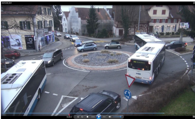
Abb. 2 : Relevé des charges directionnelles à un giratoire (Fällanden, ZH) à l'aide d'une vidéo numérique. Le relevé sous forme de film s'avère particulièrement adapté lorsque la charge de trafic est élevée, car il permet de faire un arrêt sur image et de revenir en arrière au cours de l'analyse. Les enregistrements vidéo permettent en outre d'identifier les situations conflictuelles. Image : ewp
