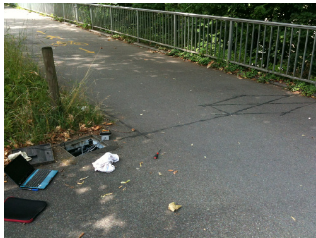
Fig. 6 : Maintenance du compteur vélo permanent situé sur la Sihlpromenade à Zurich. Les données sont transmises quotidiennement à un serveur au moyen d'un modem GSM. Source : Stadt Zürich, Tiefbauamt
